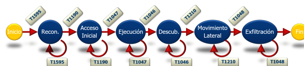
Figura 1. Modelo (autómata de estados finitos) para la secuencia de técnicas para uno de los ataques evaluados.
