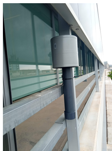
Figura 3. Prototipo nodo IoT para monitorizar calidad del aire.
