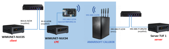
Figura 3. Testbed para conectividad de baja latencia
