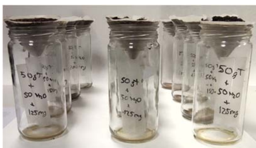
Fig. 7. Muestras de sustrato con diferentes concentraciones de NaCl durante el filtraje del agua.
